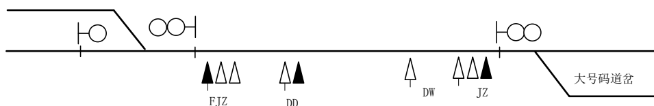
图 20 大号码道岔应答器组与定位应答器组合用设置示意
