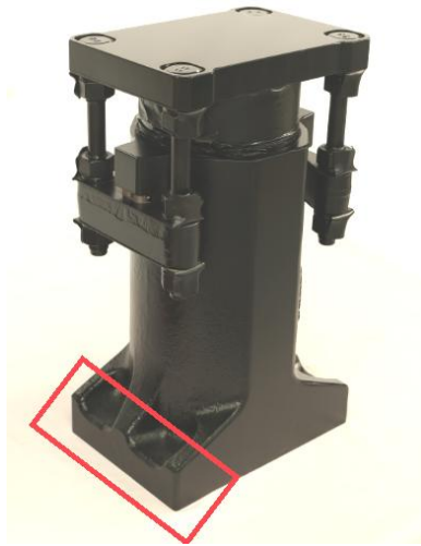
图 3 HN-1型缓冲器拉棒、化学成分取样位置
